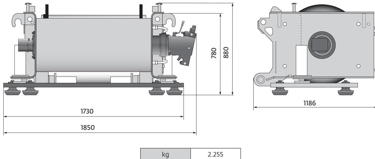
Hose reel • Schlauchtrommel • Enrouleur • Bobina de manguera • Avvolgitubo • Барабан лебедки
